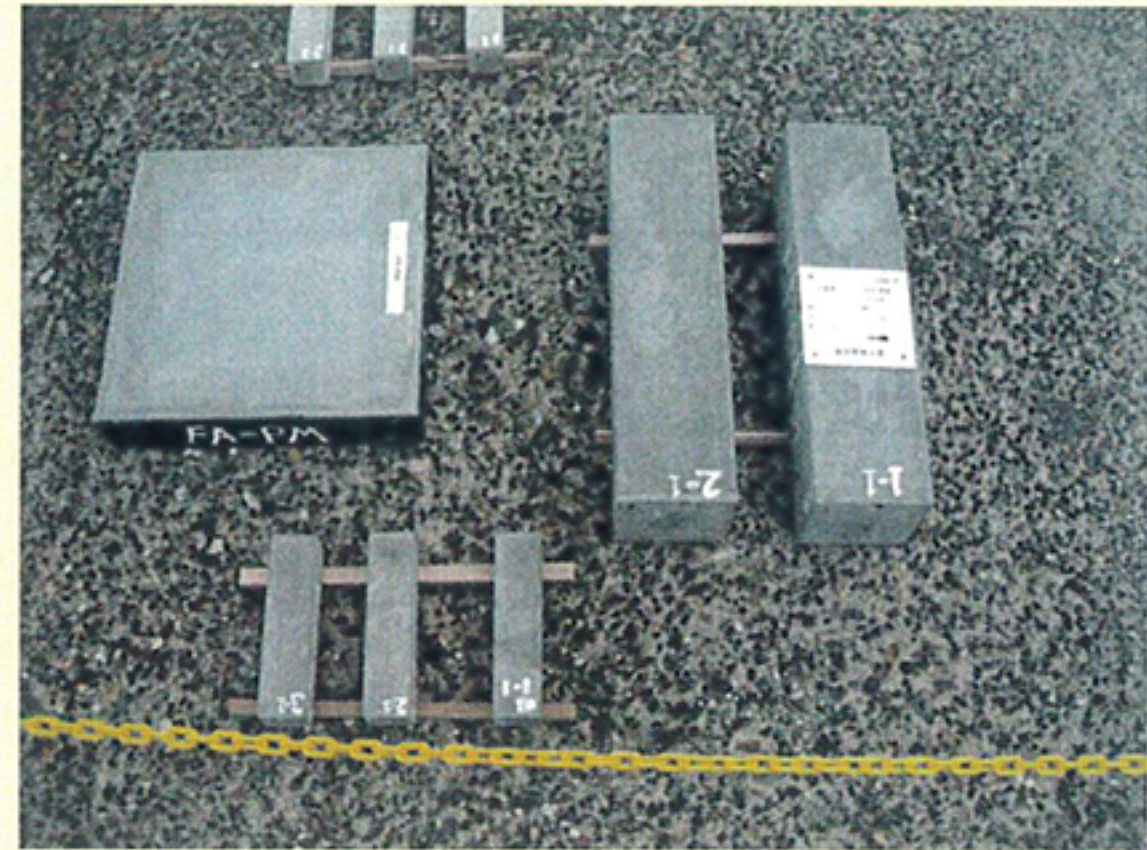
35ヶ月後の付着試験用平板、4×4×16、10×10×40試験
